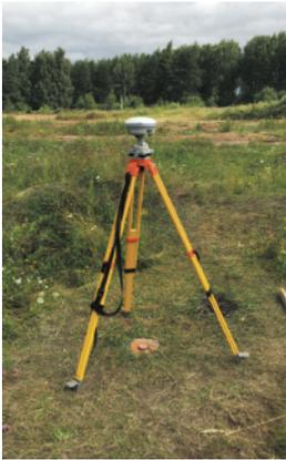
Рис. 2а Приемник South S-82 на пункте Б-20
