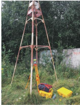
Рис. 2б Приемник Javad Махор на пункте Б-0
