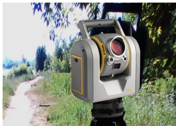
Рис.1. Роботизированный электронный тахеометр Trimble SX10, установленный на трассе, проходящей параллельно Сходненскому каналу (слева) - г. Москва полигон Группы Компаний ГиС [14].
