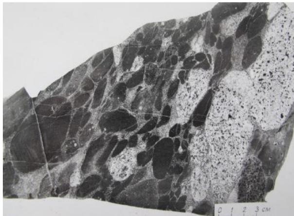
Рис.4. Фотография образца конгломерато-брекчий.
